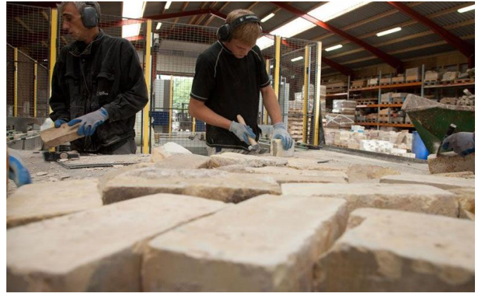
Mynd 5.8 Með vönduðu niðurrifi á byggingum með múrsteinum er hægt að hreinsa þá og nota aftur.
