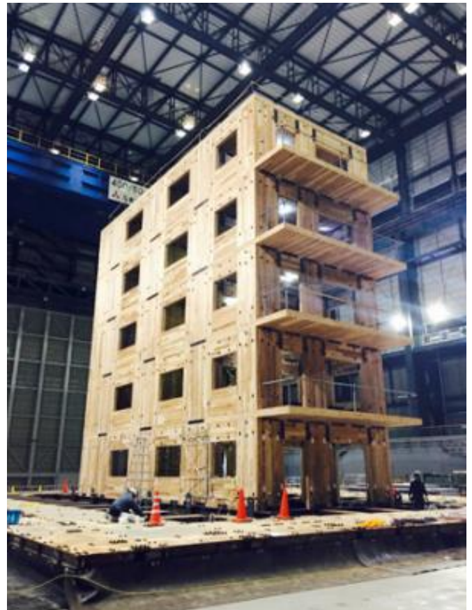
Mynd 5.11 Fimm hæða CLT einingahús úr endurnotuðum CLT einingum sem búið er að reisa á hristiborði sem hermir eftir jarðskjálftum. Heimild: Passarelli, 2018.
