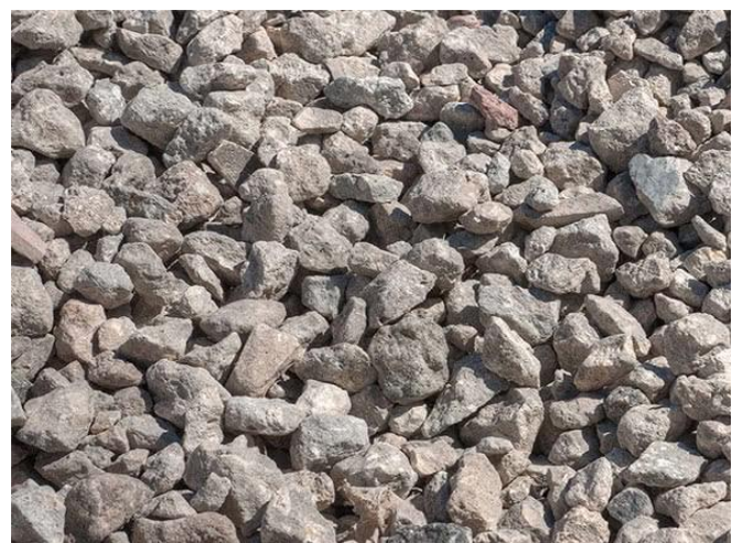
Mynd 5.6 Steypa er mulin og notuð sem fyllingarefni en við það minnkar virði og tilgangur steypunnar. Mynd sýnir malaða steypu sem er ætluð til fyllingar.
